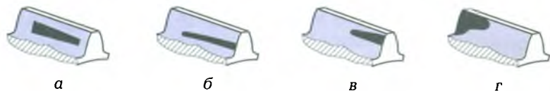
Рис. 3.22. Расположение пятен контакта при проверке «на краску»: а — правильное зацепление; б — недостаточный зазор; в, г — неправильный межосевой угол
